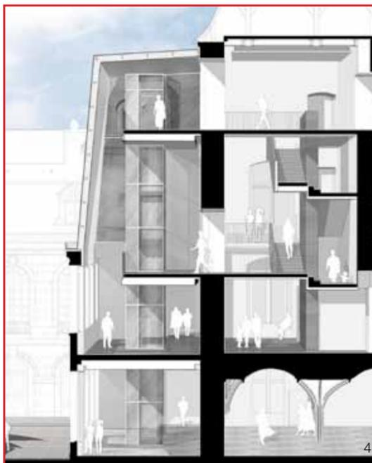
Fig. 4. *Coupe de l'escalier du parcours Moyen Âge-Renaissance*, Ateliers Lion, 2007. La création d'un ascenseur, d'un nouvel escalier et de mezzanines destinées à faciliter la circulation autour de la salle des tombeaux génère une extension en toiture.
