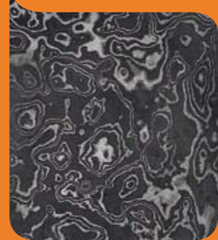
Fig. 6 Damas sauvage acier et fer, 180 couches (détail).
