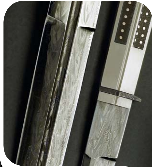
Fig. 9 Suite martiale (détail), manches : découpes par électroérosion et damas point , lames en damas styx et tranchant rapporté.
