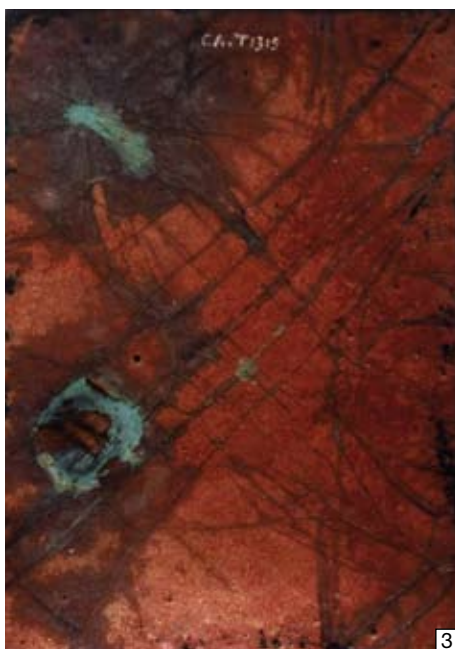
Limoges, début du XVII e siècle, Saint Pierre , au revers : perte d'émail et corrosion de la plaque de cuivre © B. Beillard
